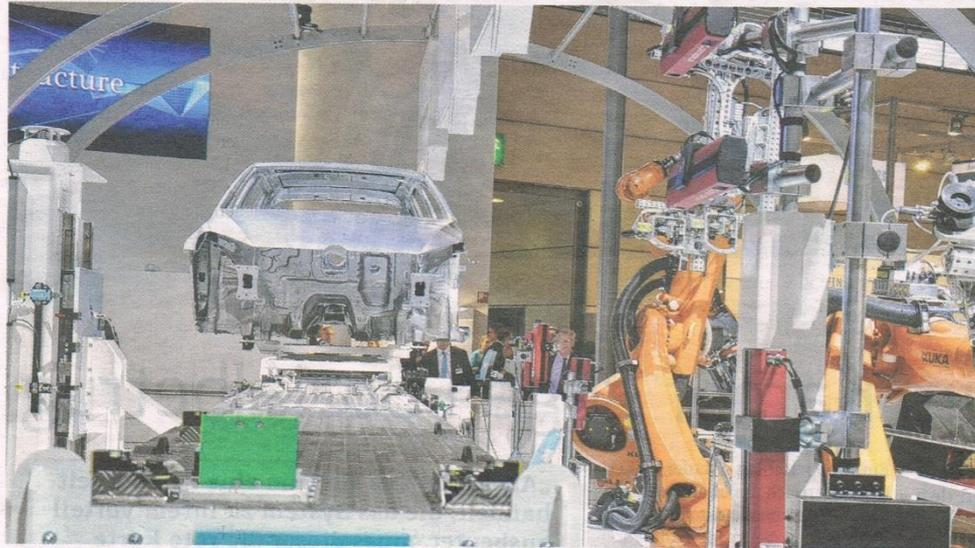
Industrie 4.0 wird die Autoproduktion revolutionieren: Ein Beispiel von Siemens gab es auf der letzten Industriemesse Hannover zu sehen – die erste Fertigungsstraße, in der Roboter die Autotüren präzise einsetzen. Die Steuerung dafür stammt aus dem Kompetenzzentrum in Linz.
